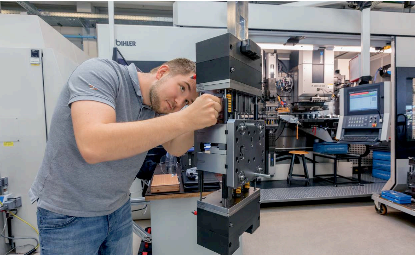
Das Schnellspannsystem des Bihler LEANTOOL-Systems sorgt für kurze Rüstzeiten bei optimaler Werkzeugpositionierung.
